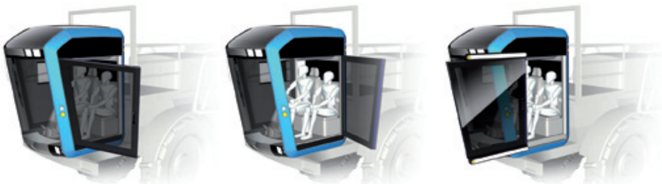
Ett exempel på AgriCabs flexibilitet: samma hytt kan enkelt utrustas med en konventionell dörr, en bakåthängd dörr eller en skjutdörr, allt för att passa den enskilda kundens behov.
